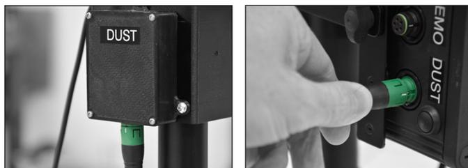
Brancher le connecteur vert dans l'emplacement «DUST» (du côté gauche).
