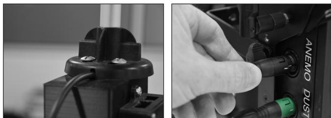
Brancher le connecteur noir dans l'emplacement «ANEMO» (du côté gauche) ou «V AIR» (si vous avez souscrit l'option du capteur vitesse d'air).
