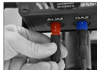
Pour recharger le boîtier, brancher le connecteur rouge dans l'emplacement «ALIM» et relier le câble à une prise électrique.
