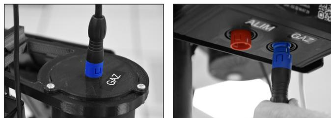
Brancher le connecteur bleu dans l'emplacement «GAZ» (sous le boîtier, du côté droit).
